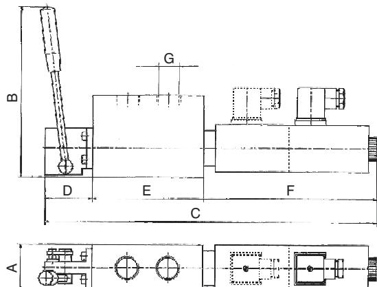
Bei dem Einsatz von 2 oder mehr Einheiten für das PL 80 muß das Zwischenelement E 60 eingesetzt werden.
